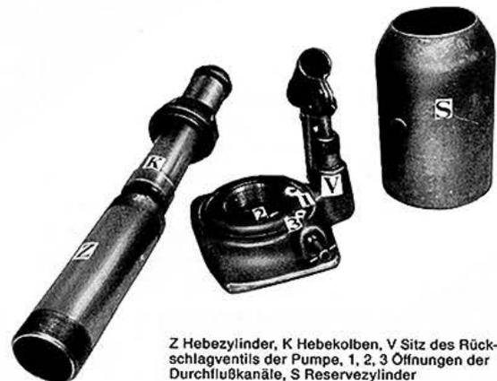
Z Hebezyylinder, K Hebekolben, V Sitz des Rückschlagventils der Pumpe, 1, 2, 3 Öffnungen der Durchflußkanäle, S Reservezylinder
