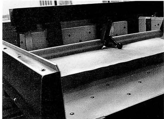
Abb. 2.3-34: Zwei Filzwalzen rollen auf dem Stapel nach vorn und drücken die Luft aus dem Stapel heraus
