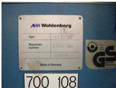
Typenschild eines Dreiseitenschneiders mit GS-Zeichen
