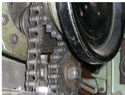
Kombinierte Scher- und Quetschstelle an einem Kettenantrieb
