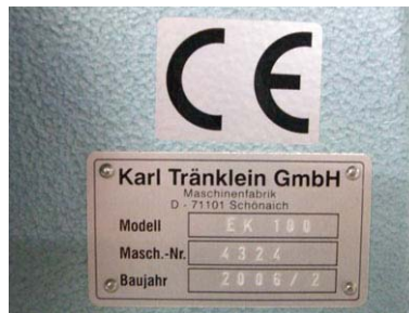
Typenschild einer Eckenrundstoßmaschine mit CE-Zeichen
