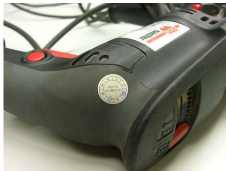
Prüfsiegel auf einem elektrischen Betriebsmittel (Handbohrmaschine)
