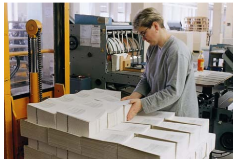
Ergonomisch günstige Höhe beim Abstapeln durch Einsatz eines Gabelhubwagens
