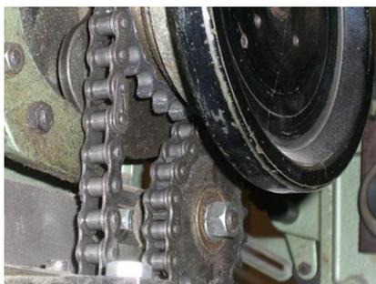
Kombinierte Scher- und Quetschstelle an einem Kettenantrieb
