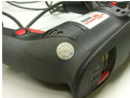
Prüfsiegel auf einem elektrischen Betriebsmittel (Handbohrmaschine)
