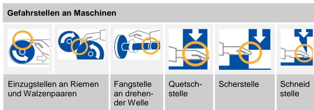
Solche Gefahrstellen treten besonders häufig auf an Zahn- und Kettenrädern, Keilriemen, Förderbändern, Speichenrädern, Wellen und Wellenenden, Walzen und Zylindern.
