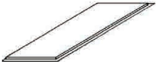
Nach dem Kaschieren werden die Seitenteile entlang ihrer Kartondicke angeschmiert und genau in den Mantelnutzen eingesetzt. Danach wird der überstehende Karton bündig entlang des Schubers abgeschnitten. Zur Masskontrolle wird das Buch in den Schubler gelegt (Achtung: Klebstoffrückstände). Allfällige Unebenheiten sind leicht zu verschleifen.
