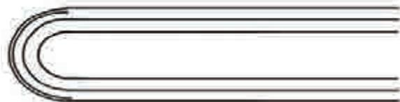
Mitgebundene Umschläge werden auf Papierfälze geklebt, damit diese einwandfrei umgelegt werden können. Wenn der Umschlag dick und beschichtet ist, ist dies sowohl bei fadengehefteten Büchern als auch bei klebegebundenen Produkten vorteilhaft.
