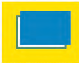
Unterfüllen: Die Aussparung im gelben Quadrat ist kleiner als das darauf gedruckte blaue Quadrat.
