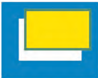
Überfüllen: Das gelbe Quadrat ist größer als die ausgesparte Fläche im blauen Quadrat.
