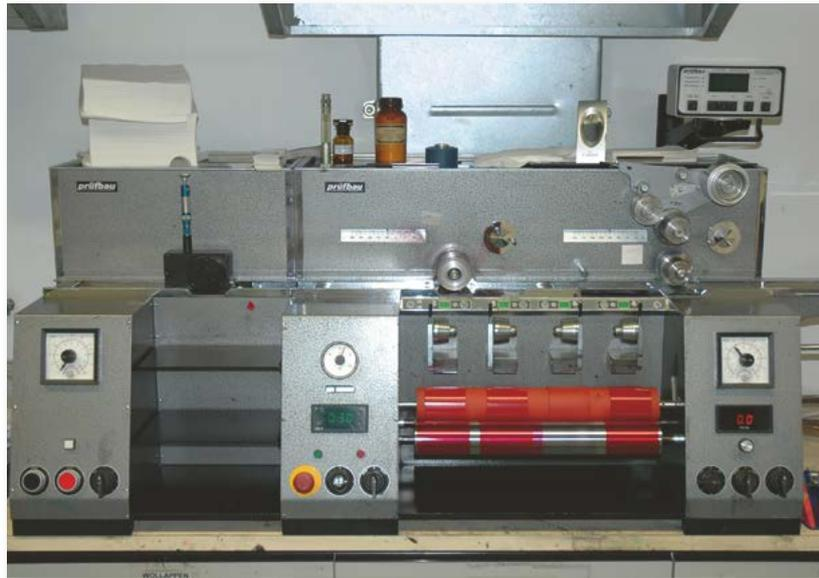
4.2.2-1: Probedruckgerät der Firma Prüfbau. Die Bestimmung der übertragenen Farbmenge erfolgt durch Wiegen der Einfärbewalze vor und nach dem Druck. Bei lösemittelfreien Farben entspricht die Differenzmasse der übertragenen Farbmasse. Aus der bedruckten Fläche, der übertragenen Farbmasse und dem spezifischen Gewicht der Farbe lässt sich die Farbschichtdicke errechnen.
